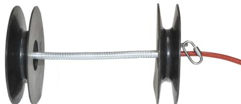
Il sistema "Double Flex" permette di sigillare una porzione interna di un tubo. Grazie alla sua flessibilità l'inserimento è molto semplice e agevole e lo speciale disegno dei dischi, a doppio bordo, garantisce sempre e comunque il sigillo, con conseguente risparmio di gas e minor tempo d'ingasamento. Sono anche compresi il flessibile d'acciaio e il tubo argon. Resistenti fino a 320°C.
