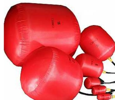
I palloni gonfiabili singoli sono progettati per sigillare ermeticamente le tubazioni prima delle saldature. Gonfiaggio tramite aria a bassa pressione. I palloni sono realizzati standard in nylon. Su richiesta è possibile averli in nitrile (per resistere ad oli e sostanze chimiche), in nomex (materiale proban) o in fibra ceramica (per resistere ad alte temperature).
