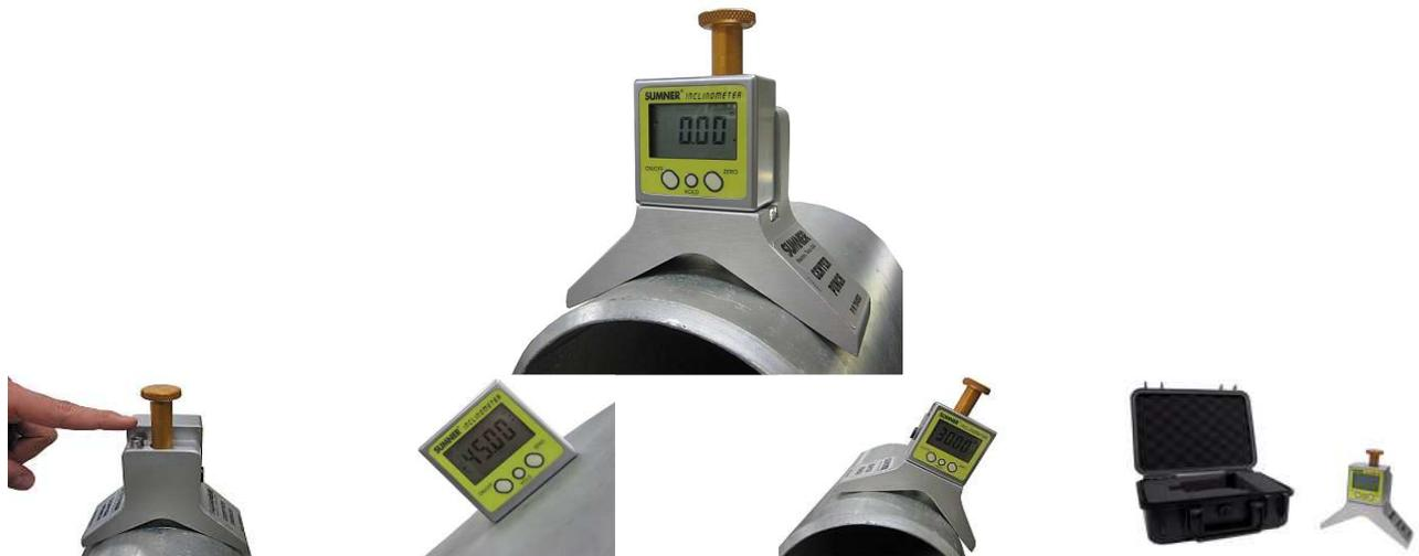
Inclinometro digitale con base magnetica utile per segnare e determinare con facilità i centri delle circonferenze di tubi. Il punzone caricato a molla, lascia un segno sulla superficie del tubo con la semplice pressione di un tasto. Può essere utilizzato anche senza il punzonatore. Viene fornito completo in una comoda valigetta.
