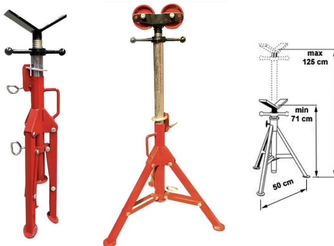
Cavalletti con doppia sicurezza con vite di fissaggio base. Regolabili in altezza con carico applicato (no testa con rullo). Anello di sicurezza con posizionamento veloce in altezza. Caduta brevettata Guard™ 25 mm tra l'anello di sicurezza. Maniglia comoda per il trasporto
