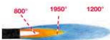
La zona più calda della fiamma è nella parte centrale. All'estremità del dardo di colore verde il bruciatore deve funzionare libero da impedimenti che limitino la circolazione dell'aria e lo scarico dei gas carburanti.
