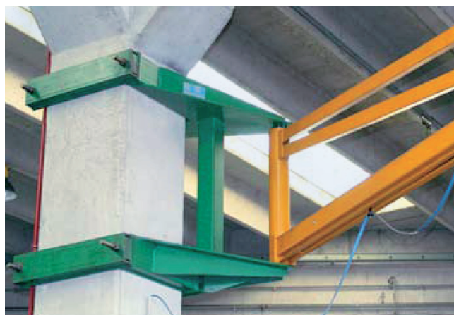
Imbragatura su spigolo. Edge anchoring.
